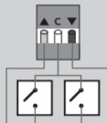
Un contact de basculement peut aussi être utilisé pour manœuvrer des produits vers le haut et vers le bas, mais sans possibilités d'arrêts variables.
