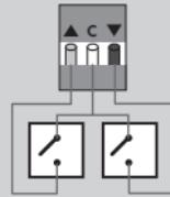
切替接点を用いても製品の上下移動はできますが、停止はできません。
